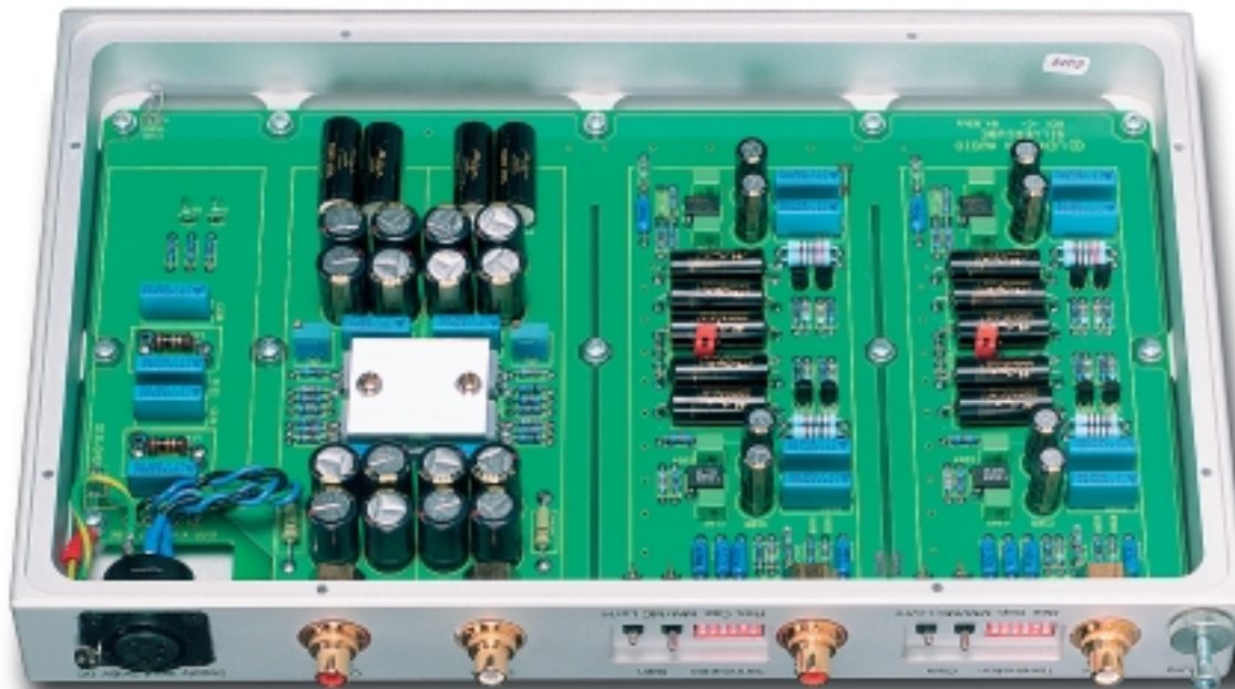
Die Aluplatte koppelt die FETs der Ausgangsstufe thermisch an das Gehäuse
