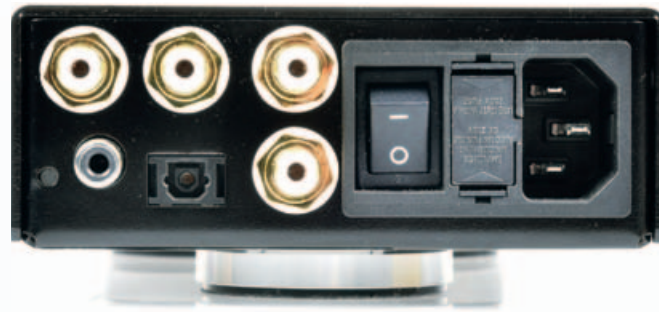
Oben: Ein- und Ausgänge in Cinch und Eingänge für digitale Quellen (1 x optisch, 1 x elektrisch) Links: Sauberer Aufbau und hochwertige Bauteile Unten: Anpassbare Verstärkung per Mäuseklavier
