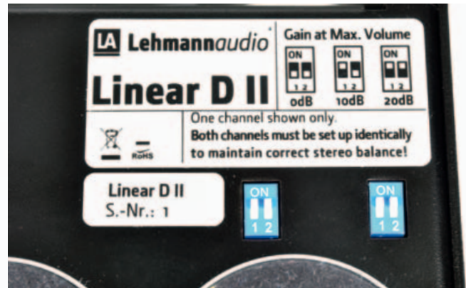
Oben: Ein- und Ausgänge in Cinch und Eingänge für digitale Quellen (1 x optisch, 1 x elektrisch) Links: Sauberer Aufbau und hochwertige Bauteile Unten: Anpassbare Verstärkung per Mäuseklavier
