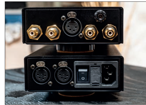
Die kleinen Rückwände des Gerätes sind komplett mit Anschlüssen besetzt
