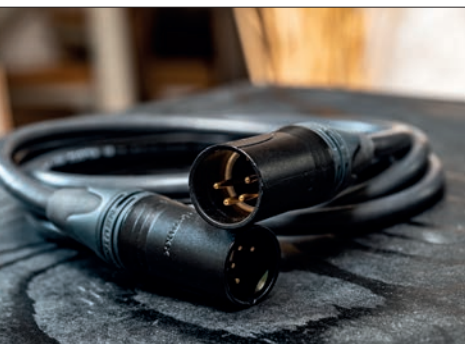
Vierpoliges XLR-Kabel: Diese Spezialverbindung koppelt das Netzteil an den Entzerrer
