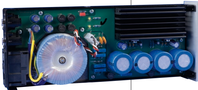
Das Netzteil ist für eine Phonovorstufe reichlich potent und wuchert mit vielen Siebkondensatoren und -spulen
